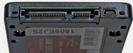
Neben den SATA-Anschlüssen bieten einige Modelle Mini-USB-Buchsen (unten), oft finden sich an gleicher Stelle Jumper-Kontakte fürs Firmware-Update (oben).
